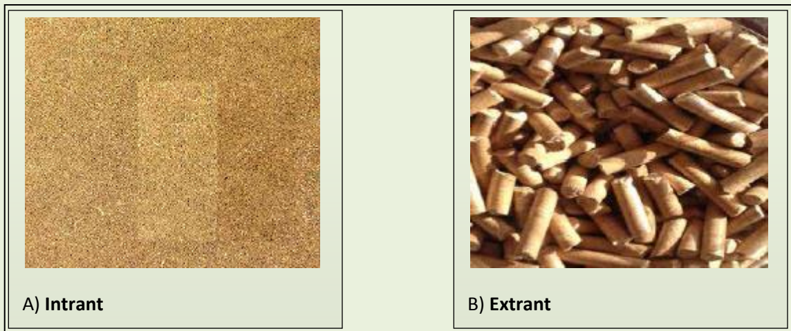
Figure 1 : Intrant et extrant du granulateur
