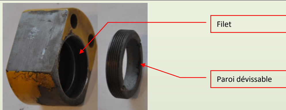
Figure 24. Vérin vu de dessous (sans le piston) avec sa paroi de chambre à piston dévissable.
