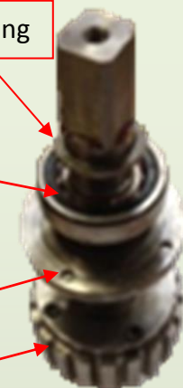
Figure 30b. Axe des rollers avec un roller retiré.
