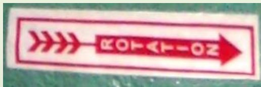
Figure 8. Inscription, placée en haut de la sortie des granules, qui indique le sens de rotation qui est toujours anti horaire.
