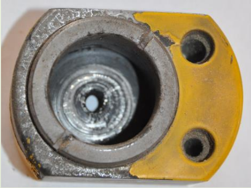
Figure 25. Vérin vu de dessous. Chambre à piston partiellement visible avec la paroi dévissable en place.
