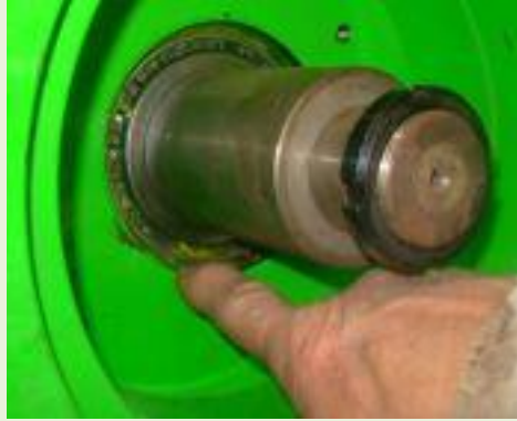
Figure 40 : Vérification de la lubrification de la bague de roulement sous le joint d'étanchéité.
